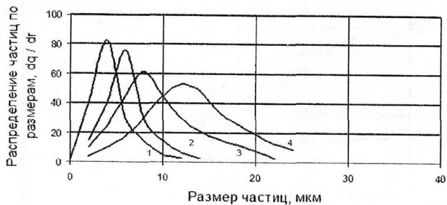
Рис. 3.23. Дифференциальные кривые распределения по размерам твердых частиц суспензионных препаратов после их мокрого измельчения: обозначения - как на рис. 3.22
