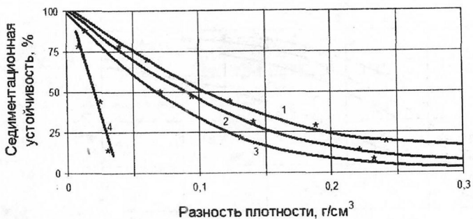
Рис. 3.10. Зависимость седиментационной устойчивости суспензии гексилур от разности плотности дисперсной фазы и дисперсионной среды: 1 - синтанол АЛМ-10; 2 - ОП-10; 3 - оксифос Б; 4 - без ПАВ
