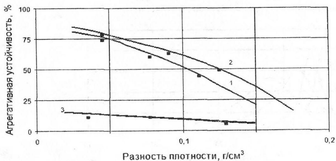
Рис. 3.21. Зависимость агрегативной устойчивости суспензионного препарата дуацил от разности плотности дисперсной фазы и дисперсионной среды: обозначения - как на рис. 3.20
