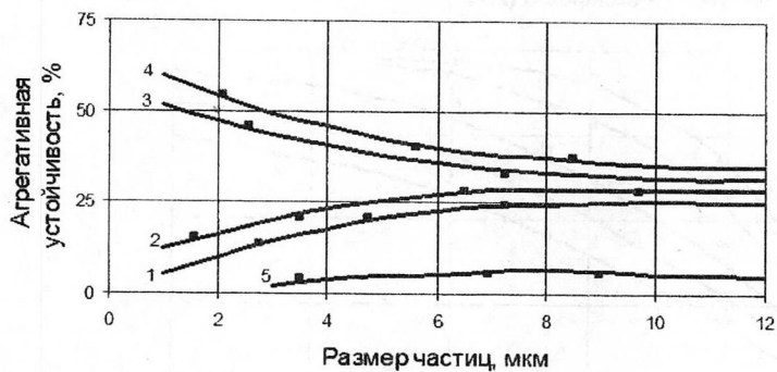
Рис.3.6. Влияние размеров частиц твердой фазы на агрегативную устойчивость суспензии гексилур : обозначения - как на рис. 3.5
