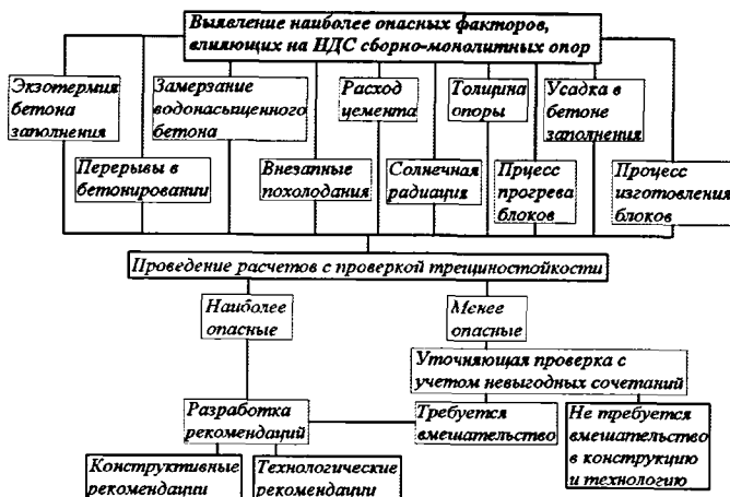
Рис. 3. Блок-схема методики выявления наиболее опасных факторов, влияющих на НДС сборно-монолитных опор.
