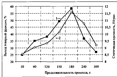
Рисунок 3 - Влияние продолжительности окатывания на выход (1) и статическую прочность (2) гранул товарной фракции
