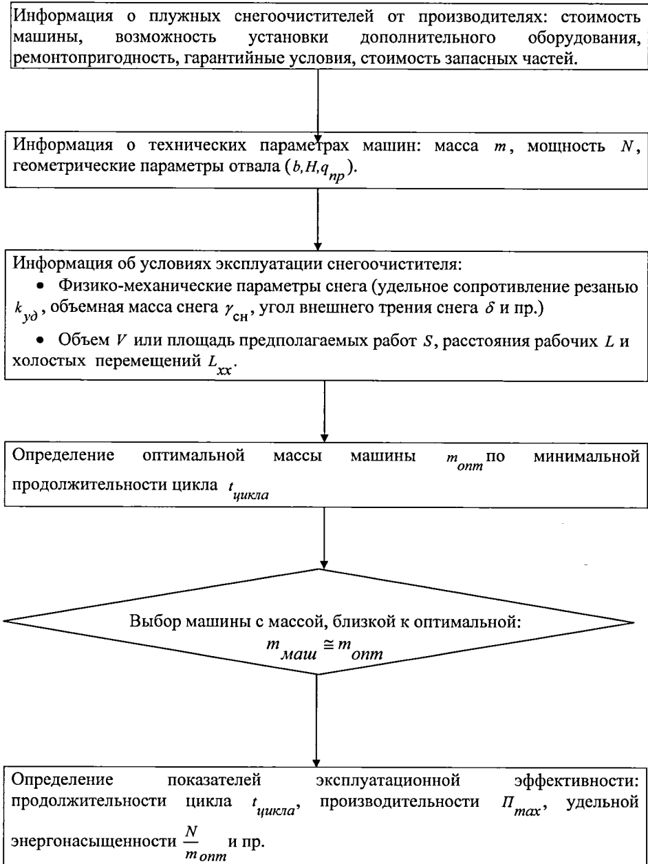
Рис.4. Логическая структурная схема выбора оптимального плужного снегоочистителя в зависимости от условий эксплуатации
