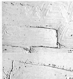
Рис. 3. Дислокации в границах ростовых ячеек, поперечный срез (211)-кристалла.
