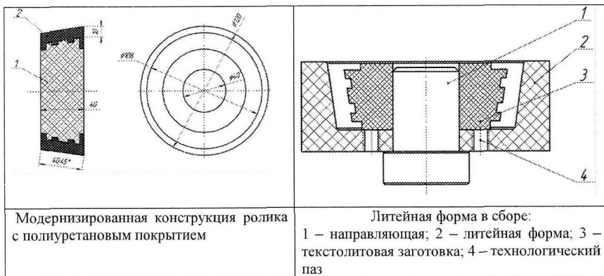
Рис. 10. Технология получения модернизированного ролика
