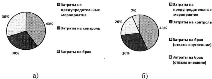
Рис. 3. Соотношение затрат на качество: а) в точке локального минимума; б) по результатам обследования предприятий Тамбовской области
