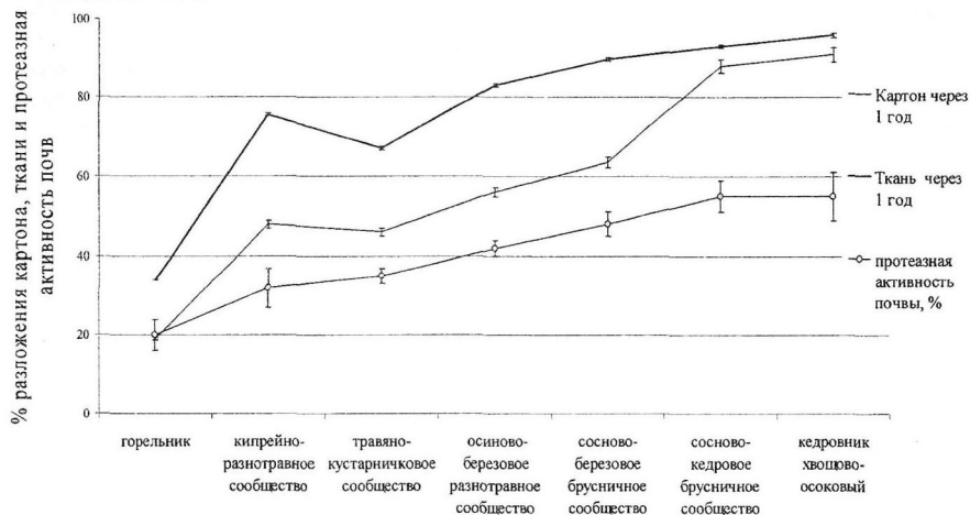
Рис. 3 – Целлюлозоразлагающая и протеазная активность почв на разных этапах послепожарного восстановления леса
