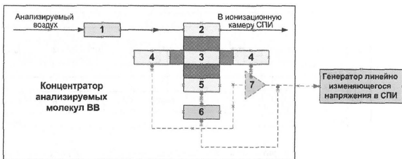
Рисунок 5 - Блок-схема концентратора анализируемых молекул ВВ;
