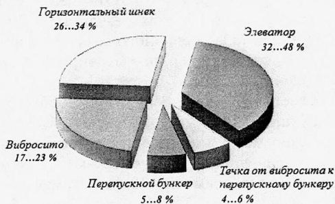
Рис. 6 – Структура тепловых потерь в контуре внешней циркуляции материала слоя (Общие тепловые потери в контуре составляют 0,37...0,54 МВт)
