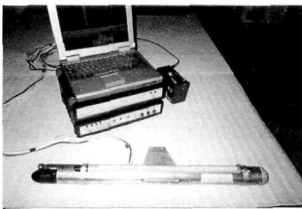
Рис. 9. Гидролокационный комплекс MKS: наборный носитель антенн ГБО и эхолота (черный цвет), электронный блок (внизу), в центре цифровой модуль ввода-вывода и вверх ПЭВМ типа Ноутбук.
