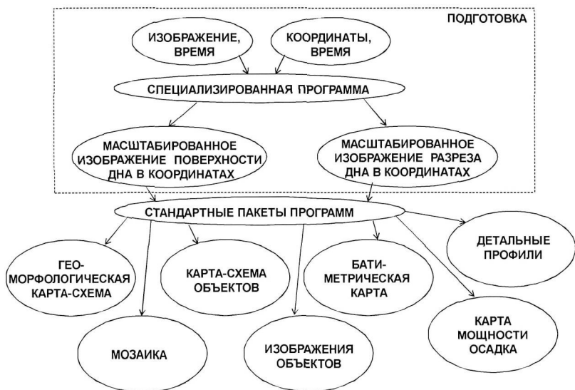
Рис. 4. Схема, иллюстрирующая методологию построения процесса обработки гидролокационной информации
