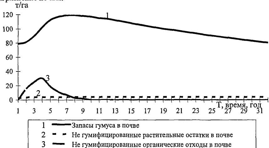
Рис. 6 Прогноз по запасу гумуса в почве Рубцовского района при использовании осадка сточных вод в качестве удобрений первые 4 года.
