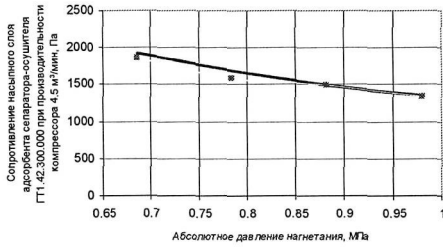
Рис. 6. Сопротивление насыпного слоя адсорбента сепаратора-осушителя ГТ1.42.300.000 при производительности компрессора 4,5 м 3 /мин в диапазоне абсолютных давлений от 0,69 до 0,98 МПа: расчетное – сплошная линия; данные испытаний – точки
