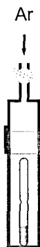
Рис. 3. Схематическое изображение ампулы и автоклава для проведения синтеза при повышенном давлении CF_3I
