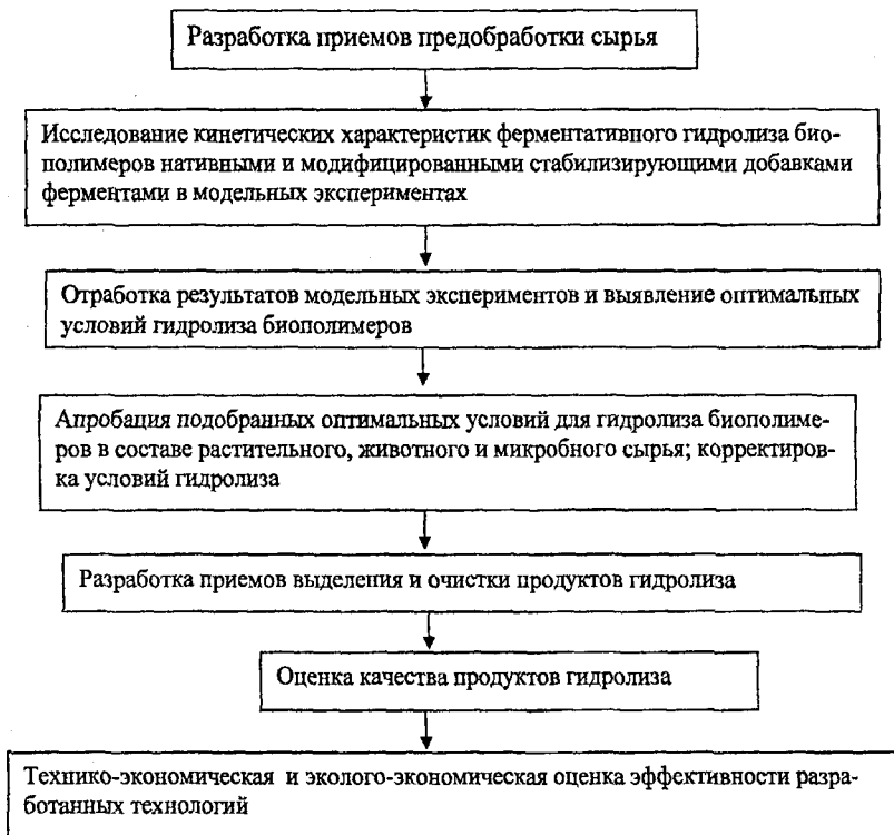
Рис. 1. Принципиальная схема получения гидролизатов биополимеров.
