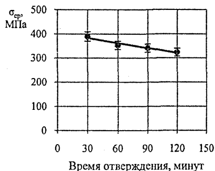
Рисунок 8 – Зависимости разрушающего напряжения при изгибе \sigma_f (а) и при сжатии \sigma_{ср} (б) базовой композиции от времени отверждения при 190 °С
