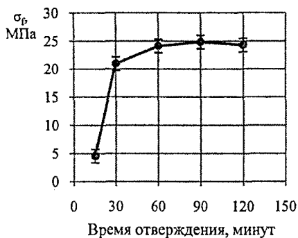
Рисунок 8 – Зависимости разрушающего напряжения при изгибе \sigma_f (а) и при сжатии \sigma_{ср} (б) базовой композиции от времени отверждения при 190 °С
