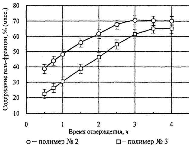
Рисунок 6 – Влияние времени отверждения полиэфиров на основе резорцина серной системой на содержание гель-фракции при температуре 190 °С
