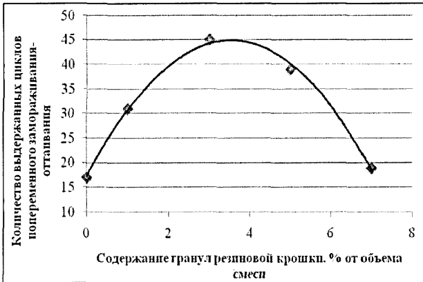
Рис.3.1 Зависимость морозостойкости цементобетона от количества введенных в его состав гранул резиновой крошки
