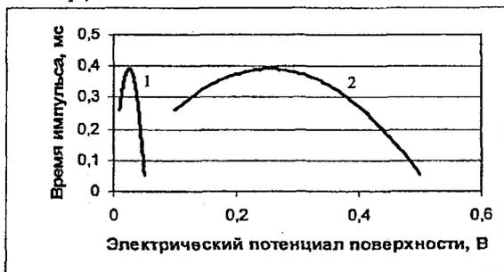
Рис.11. Зависимость необходимого времени импульса для дефлокуляции частиц, от электрического потенциала поверхности: 1 – магнетит, 2 – кварц
