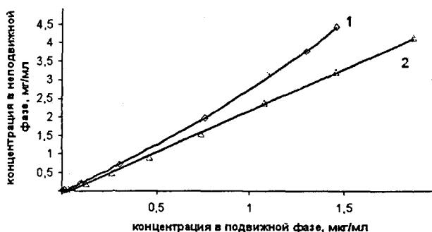
Рис. 2. Изотермы распределения этилового спирта при 65°C (1) и 78°C (2).
