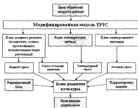
Рис. 1. Блок-схема модернизированной модели ЕРІС (серым выделены измененные блоки)
