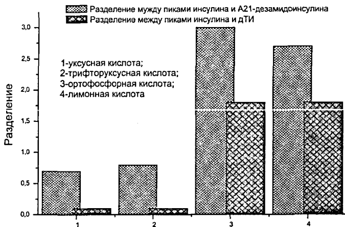
Рис. 4. Влияние различных кислот в составе подвижных фаз на разделение между пиками инсулина и A21-дезамидоинсулина и между пиками инсулина и дТИ.
