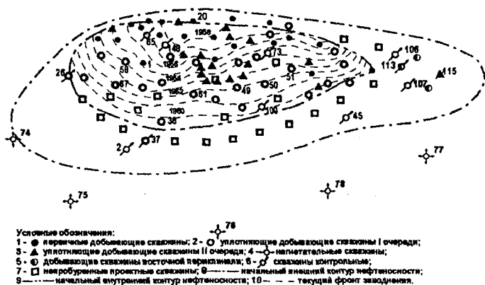
Рис. 6. Схемы размещения скважин и продвижения фронта заводнения пласта Б 2 Зольпенского месторождения
