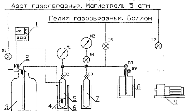
Рис. 4. Схема установки дистилляционной очистки фосфина
