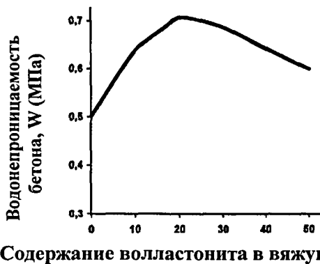
Рис 3 Зависимость водонепроницаемости бетона от содержания минеральной добавки волластонита в составе обычного портландцемента
