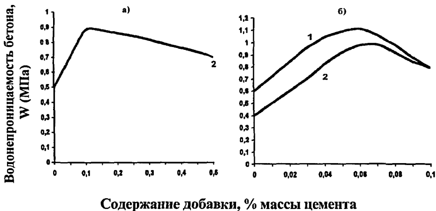
Рис 2. Водонепроницаемость бетона состава 1:1,57:2,57:0,4 с и без МЛСТ (а) и бетона состава 1:1,3:2,33:0,38 с и без декстрина (б) в составе сульфатостойкого (1) и обычного (2) портланд-цементов
