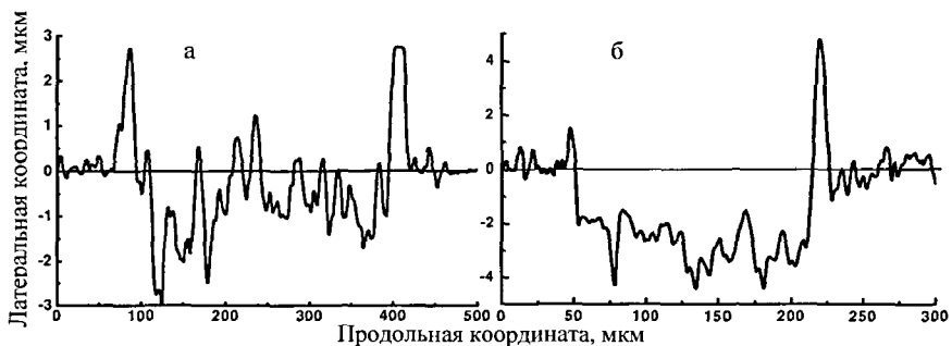
Рис.1 Профилограммы кратеров, полученных при испарении алюмолитиевого сплава (а) и отожженного феррита лития (б) 50 импульсами лазерного излучения
