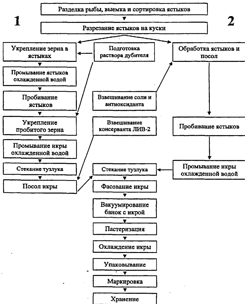
Рис. 11. Технологические схемы изготовления икры из жировых ястыков: 1 – схема по патенту № 2050780, 2- схема по заявке №2006111010
