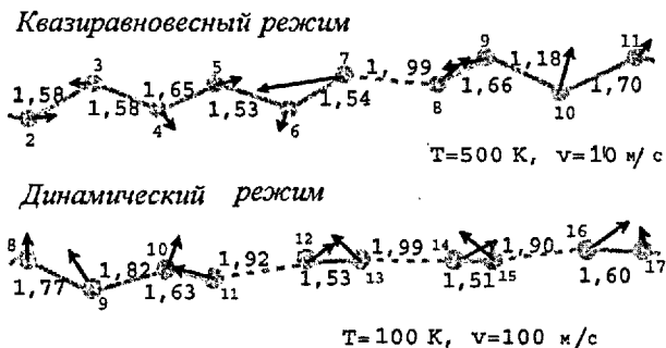
Рис. 2: Направления скоростей атомов и длины связей в момент разрыва (пунктирные линии соответствуют рвущимся связям).
