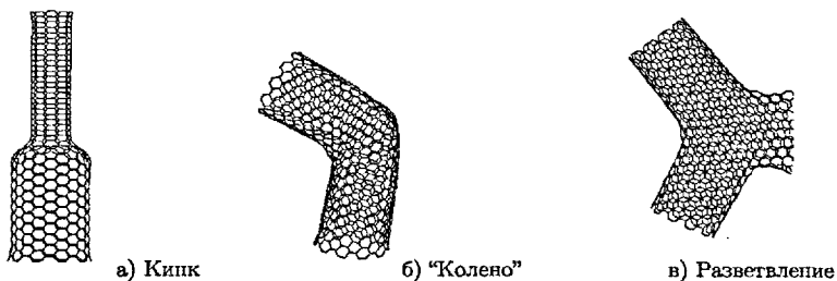
Рис. 1: Структурные и топологические типы дефектов УНТ
