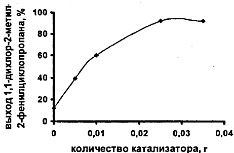
Рис.2 Влияние количества катализатора триэтилбензиламмонийхлорида (ТЭБАХ) на выход продукта 1a (0,1 моль \alpha -метилстирола, 0,4 моль \text{CHCl}_3 , 4 моль 50% NaOH, межфазный катализатор ТЭБАХ, время 3 часа).
