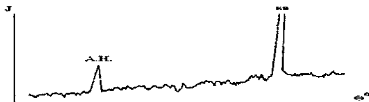
Рис.7. Рентгенограмма остатка цеолита после солянокислотного разложения. А-анальцин; Н-натролит; Кв-кварц.
