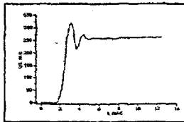
Рис. 3. Однородная стальная преграда в t = 12 мкс и профиль скорости тыльной поверхности
