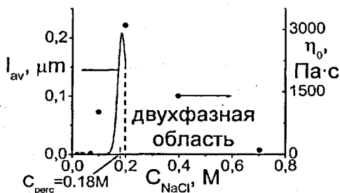
Рисунок 7. Рассчитанная зависимость средней длины мицелл от концентрации NaCl для раствора хлорида зруцилбис(2-гидроксиэтил)метиламмония (ЕНАС) (40mM) и экспериментальная зависимость вязкости при нулевой скорости сдвига (25°C).
