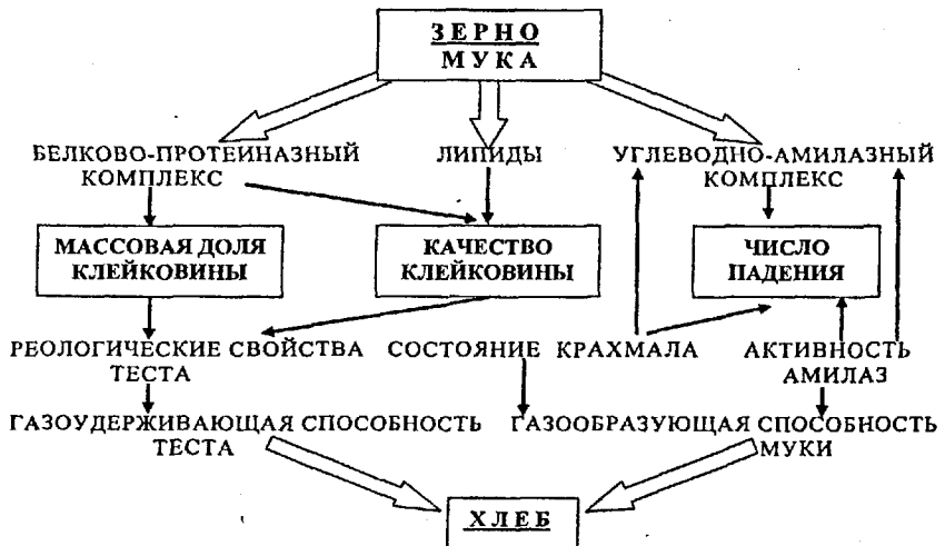
Рис. 4. Обобщенная схема взаимосвязи технологических свойств зерна, муки, реологических свойств теста и качества хлеба
