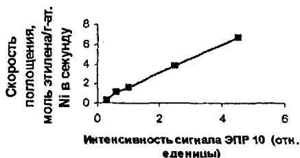
Рис. 15. Зависимость активности системы Ni(PPh_3)_4/BF_3 \cdot OEt_2 ( B : Ni = 70 ) в олигомеризации этилена от интенсивности сигнала ЭПР 10.
