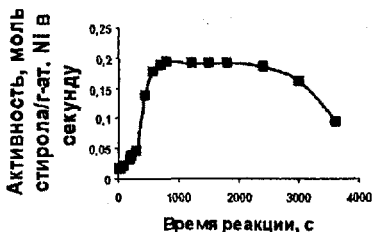
Рис. 17. Зависимость активности каталитической системы Ni(PPh_3)_4 / BF_3 \cdot OEt_2 (B : Ni = 4) в олигомеризации стирола от времени реакции t = 23^\circ C (Ni : стирол : толуол = 1:800:1600).
