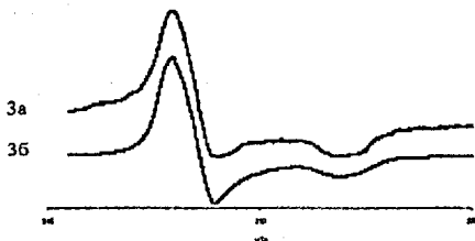
Рис. 4. Экспериментальный (3а) и моделированный (3б) спектры ЭПР комплекса Ni(I) (PPh_3)_3NiOEt в толуоле при T = 77 K .
