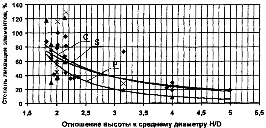
Рисунок 7 – Влияние геометрии слитка ( H/D ) на ликвацию
