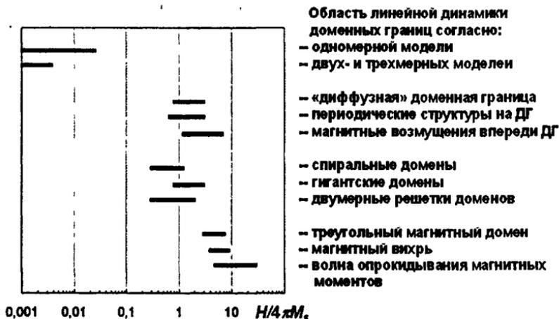
Рис. 1. Области формирования динамических доменных структур в материале с параметрами: фактор качества  $Q = H_w/4\pi M_s = 10$ , константа затухания  $\alpha = 0,05$ .  $H/4\pi M_s$  - нормированная величина действующего магнитного поля.
