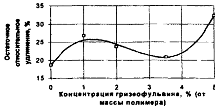
Рис. 4. Зависимость физико-механических характеристик ГТАЦ волокон от содержания введенного гризеофульвина: а - P_{ост} = f(C) ; б - E_{ост} = f(C) .
