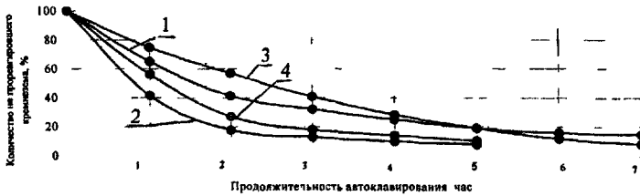
Рис. 3. Зависимость количества непрореагировавшего кремнезема от продолжительности автоклавной обработки 1-2 - удельная поверхность песка 700 м 2 /кг, 3-4 - удельная поверхность песка 800 м 2 /кг, 1-3 - температура 150°C, 2-4 - температура 180°C.
