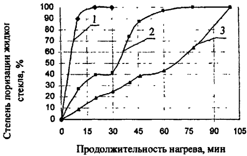
Рис. 10. Продолжительность образования пористого материала из жидкого стекла в зависимости от скорости нагрева. 1 - скорость нагрева 17 град/мин, 2 - скорость нагрева 4 град/мин, 3 - скорость нагрева 3,5 град/мин.
