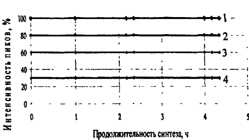
Рис. 7. Зависимость интенсивности рентгеновских отражений продуктов синтеза жидкого стекла с М-3.0 на основе трепела Благодатенского месторождения: 1 — 0,335 \cdot 10^{-9} м, 2 — 0,182 \cdot 10^{-9} м, 3 — 0,154 \cdot 10^{-9} м, 4 — 0,246 \cdot 10^{-9} м (кварц).
