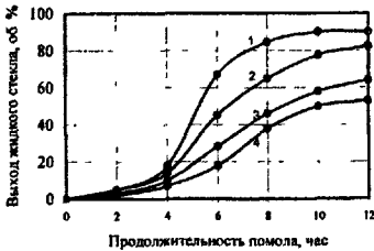
Рис. 5. Зависимость выхода жидкого стекла от модуля и продолжительности помола:
