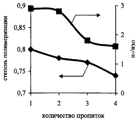
Рис. 3. Влияние количества пропиток на состав углеводородов C_{5+}
