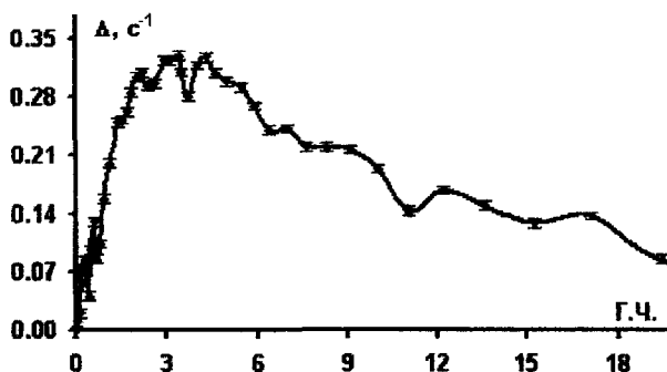
Рисунок 13 - Зависимость параметра избыточной релаксационной эффективности в системе \text{H}_2\text{O} -N,N-диметилформамид от Г.Ч. (298 К)
