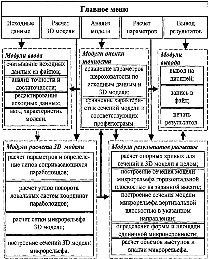
Рис. 5. Структурно-функциональная схема программного комплекса построения трехмерной модели шероховатой поверхности
