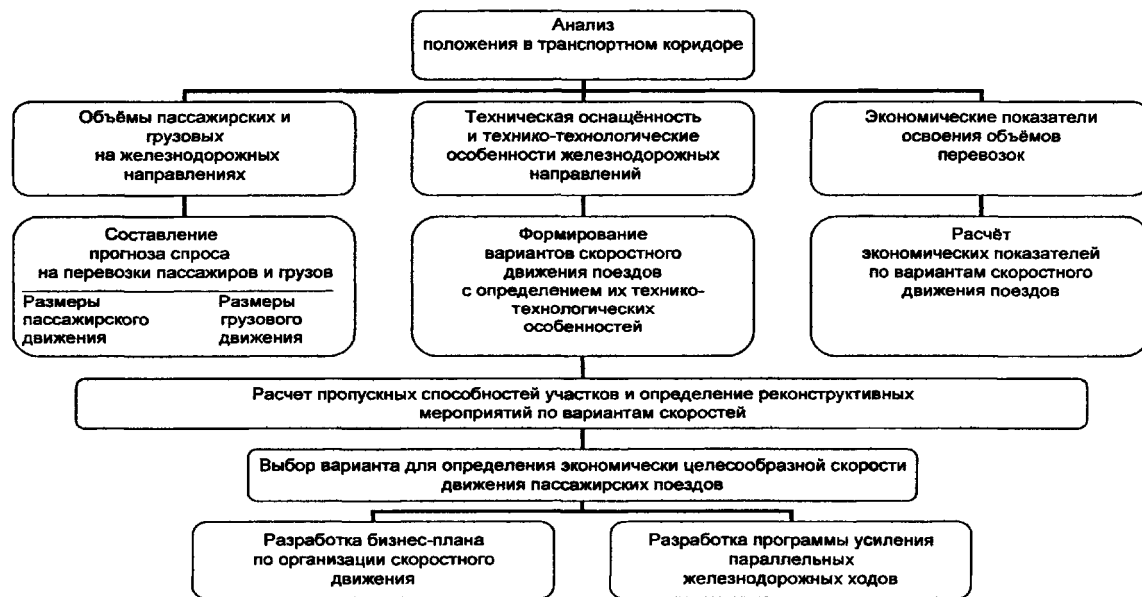
Рис. 5. Последовательность действий при оценке вариантов организации скоростного движения поездов на существующих железных дорогах
