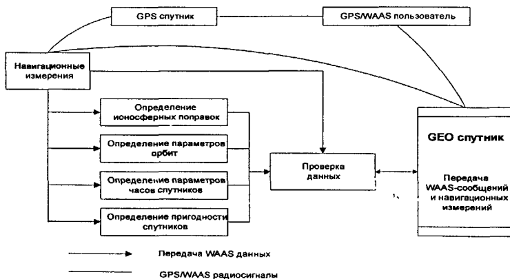
Рис. 6. Блок-схема наземного комплекса системы WAAS.
