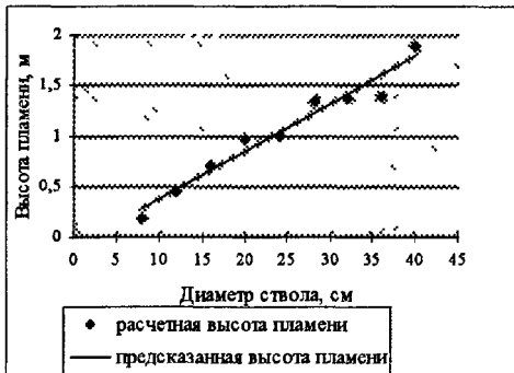
Рисунок 4 - Средняя допустимая высота пламени в зависимости от диаметра ствола (сосна)
