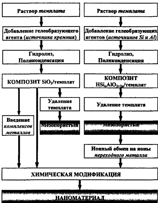
Рис. 1. Схема синтеза нанокompозитов на основе мезопористых материалов.
