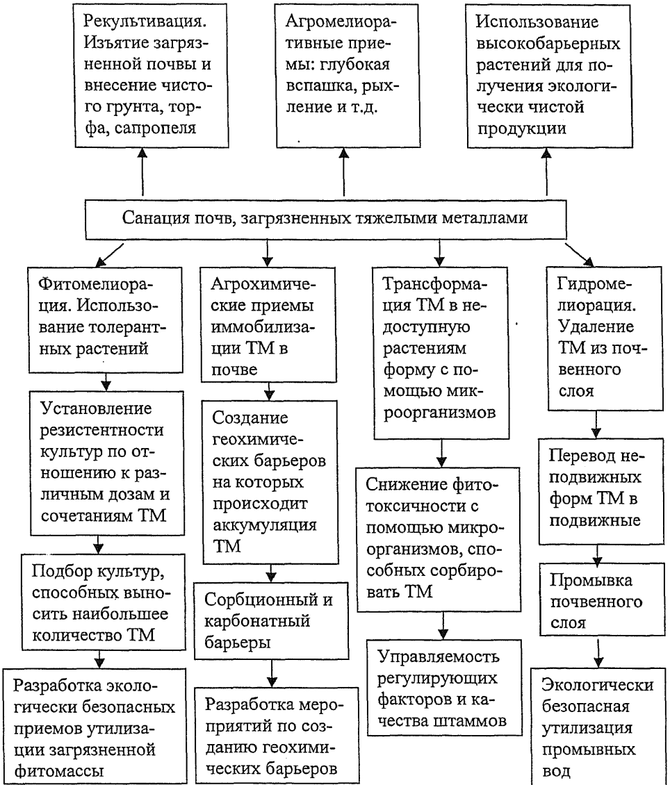
Рис. 2. Схема санации почв, загрязненных тяжелыми металлами
