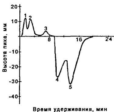
Рис. 4. Хроматограмма анионов некоторых карбоновых кислот (одноколоночный вариант).
