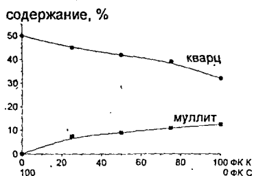
Рис. 1. Изменение содержания кристаллических фаз в керамике в зависимости от соотношения ФК К и С типов в исходной смеси.
