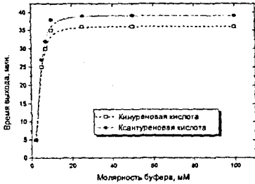
Рис. 9. Зависимости времен выхода метаболитов триптофана от молярности буфера (а) и от содержания ацетонитрила в элюенте (б).
